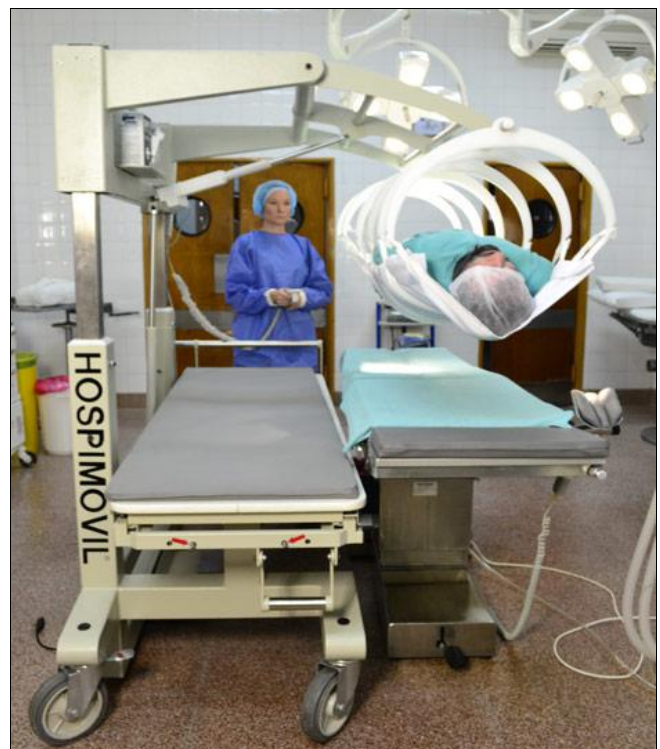
Fig. 3. El vehículo transbordando un paciente a mesa de cirugía sin intervención de esfuerzos humanos.
