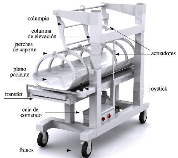
Fig. 1. Vista fronto-lateral del vehículo
